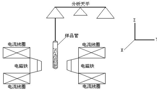
(图一) 古埃磁天平工作原理示意图
